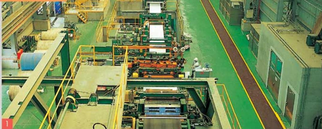
冷軋部包含一廠區、二廠區及三廠區，擁有冷軋機6台、熱軋／冷軋退火酸洗線各2條，鋼捲準備線、研磨拋光線、光輝退火線、調質軋延機、張力整平線、調質整平連續線等多條產線，製程完整，可提供下游客戶高品質、多樣化及客製化的冷軋產品，包括No.1、2D、2B及BA鋼捲，年產能70萬噸。
